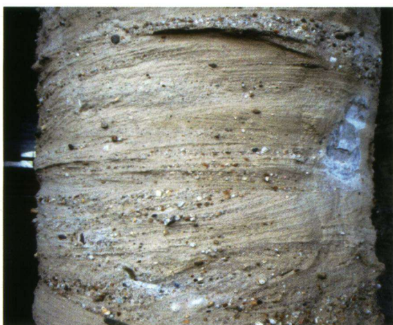
Afbeelding 4. Grindige zanden met parallelle laminatie, flauw-hellende scheve gelaagdheid en ondiepe geultjes die met grind zijn gevuld. Aan de rechterkant van de paal komt het beton onder het zand vandaan.
